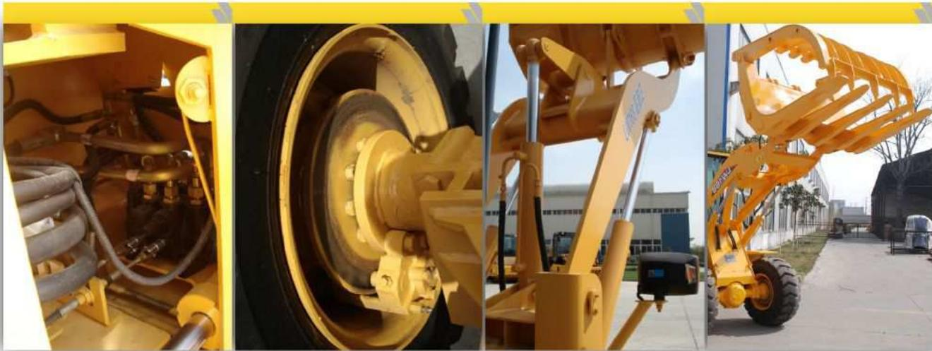
La cargadora LW188, diseada para trabajos exigentes y de alto rendimiento. Traccion integral en las 4 ruedas, freno a discos y chasis con rotacion de 35 en ambas direcciones. El costo mas bajo en operacion y mantenimiento
